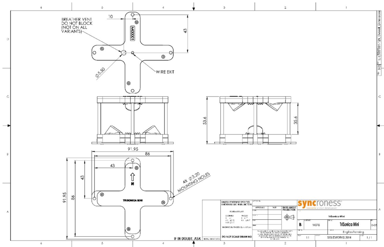
FIGURE 1: TRIASONICA MINI FLAT BASE DRAWING
