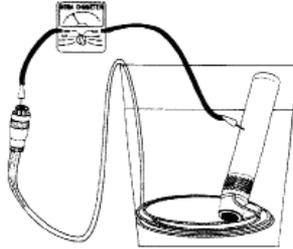
Figure 13: Using an Ohm Meter
