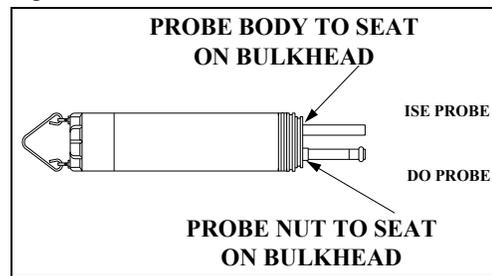
**INSTALLING THE PROBE GUARD**
