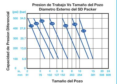
**IMPORTANTE:** Las tasas sugeridas que se muestran en la gráfica no son una medida de la capacidad de anclaje del empacador, la cual puede ser menor a la presión de trabajo sugerida y puede variar bajo ciertas circunstancias. Consulte a Geotech para detalles.
