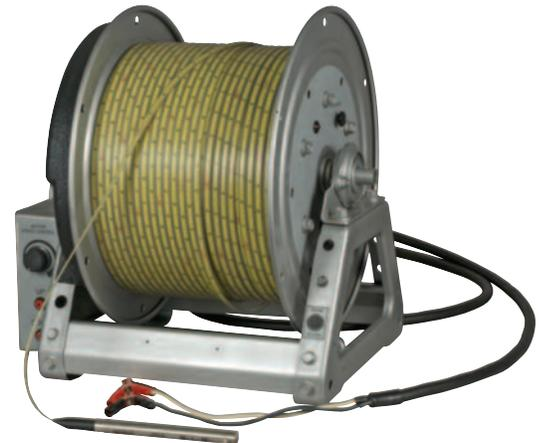
Medidor del nivel de agua de 2000' (600m)
